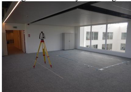
Figure 6: Prise de mesure au moyen du laser scanner P40
